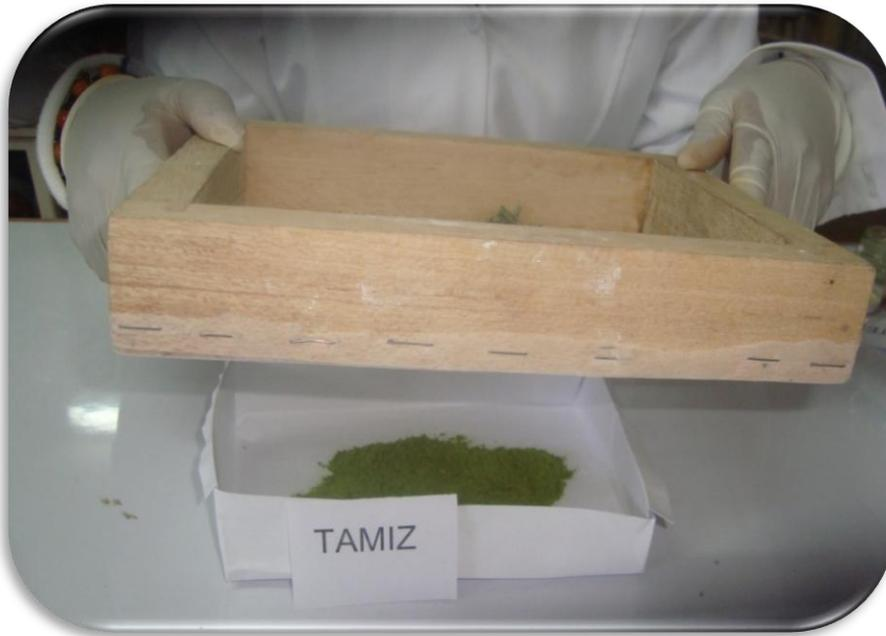
UNA VEZ YA DESECADO SE PASO A FRACCIONAR LA DROGA PARA LUEGO PULVERIZARLO EN UN TAMIZ
